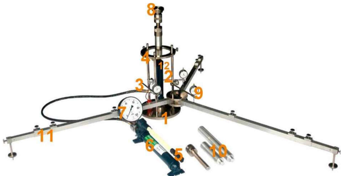
Rys. 1.1. Aparatura VSS z trzypunktowym pomiarem przemieszczenia płyty
