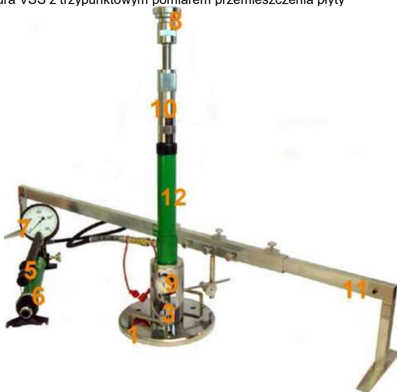
Rys. 1.2 Aparatura VSS z jednopunktowym pomiarem przemieszczenia płyty
